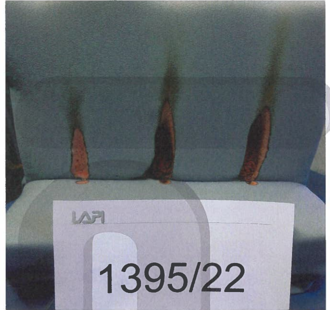
Foto 2: dopo la prova / Picture 2: after testing
