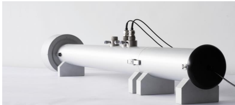
Figura 3 – Tubo per la misura dell'impedenza
